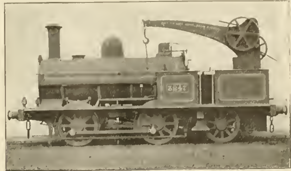
FIG. 3. CRANE ENGINE L. & N. W. RY.
